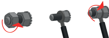
Figura 7. Conexión del equipo a una instalación equipotencial.
